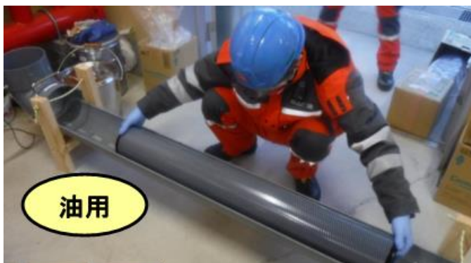
↑硬質塩ビパイプ。内径 200mm、長さ 2000mm
