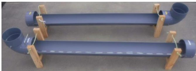
↑硬質塩ビパイプ。内径 200mm、長さ 2000mm
